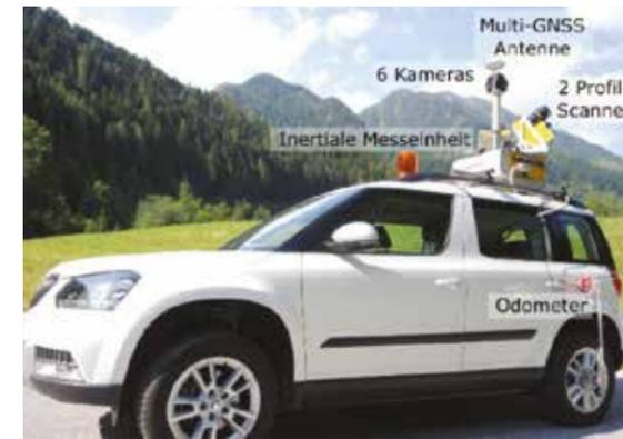
Abb. 8: Komponenten eines MMS
