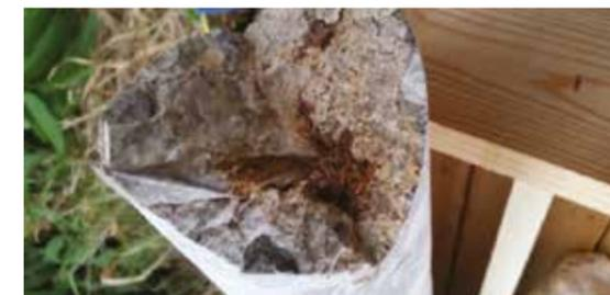
Abb. 3: Bohrkern durch die Arbeitsfuge einer Winkelstützmauer
